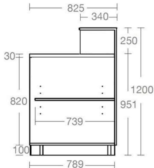
Banco Bar Neutro, linea Basic, composto da struttura in legno nobilitato colore Grafite, con piano interno regolabile in altezza, zoccolo posteriore ispezionabile in legno e zoccolo anteriore in ferro verniciato Micaceo. Montato su piedini metallici regolabili in altezza dall'interno mediante chiave a brugola, Bancalina e Piano di lavoro di Serie in laminato colore Ardesia, Frontale in legno di colore Grafite.
