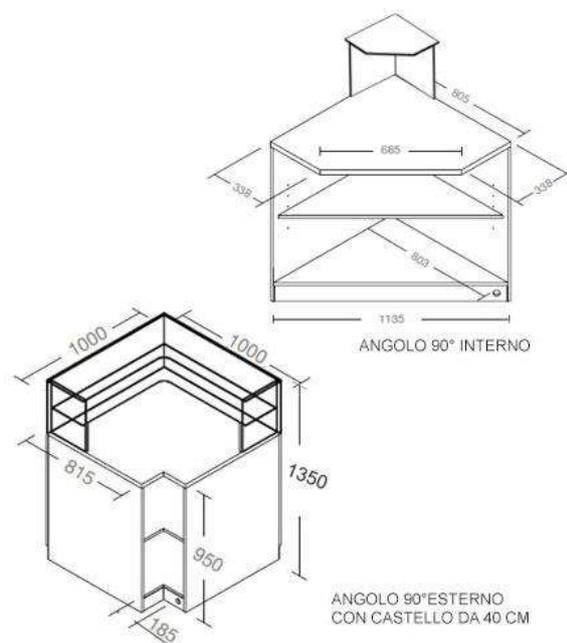
Banco ad Angolo con castello in vetro, linea Basic, composto da struttura in legno nobilitato colore Grafite, con piano interno regolabile in altezza, zoccolo posteriore ispezionabile e zoccolo anteriore in ferro verniciato Micaceo. Montato su piedini metallici regolabili in altezza, Top di Serie in laminato colore Ardesia. Frontale il legno colore Grafite, castello in vetro alto 40 cm con piano intermedio.
