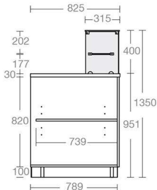
Banco Neutro con castello in vetro, linea Basic, composto da struttura in legno nobilitato colore Grafite, con piano interno regolabile in altezza zoccolo posteriore ispezionabile in legno e zoccolo anteriore in ferro verniciato Micaceo. Montato su piedini metallici regolabili in altezza dall'interno mediante chiave a brugola, Top di Serie in laminato colore Ardesia Frontale in legno di colore Grafite, castello in vetro alto 40 cm con piano intermedio.
