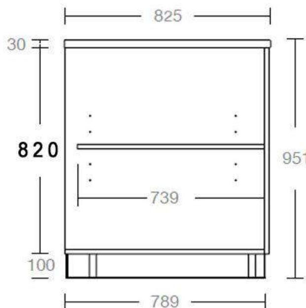
Banco Cassa Neutro linea Basic, composto da struttura in legno nobilitato colore Grafite, con piano interno regolabile in altezza, zoccolo posteriore ispezionabile e zoccolo anteriore in ferro verniciato Micaceo. Montato su piedini metallici regolabili in altezza dall'interno mediante chiave a brugola, Top di Serie in laminato colore Ardesia Frontale il legno colore Grafite.
