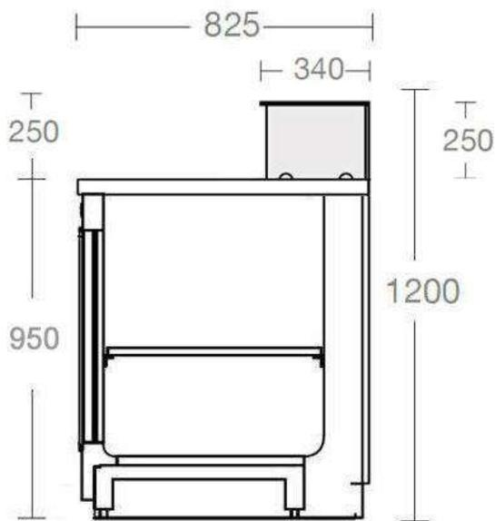
Banco Refrigerato Statico con teca in vetro, linea Basic, composto da struttura portante in tubolare d'acciaio verniciato a polveri e piedi regolabili, e zoccolo anteriore in ferro verniciato Micaceo, motore incorporato, Temperatura +4°C +8°C, cella in acciaio inox con sportelli, Top di Serie in laminato colore Ardesia e Frontale in legno di colore Grafite, banco che necessita di scarico dell'acqua, teca in vetro alta 25 cm con vetro temprato.
