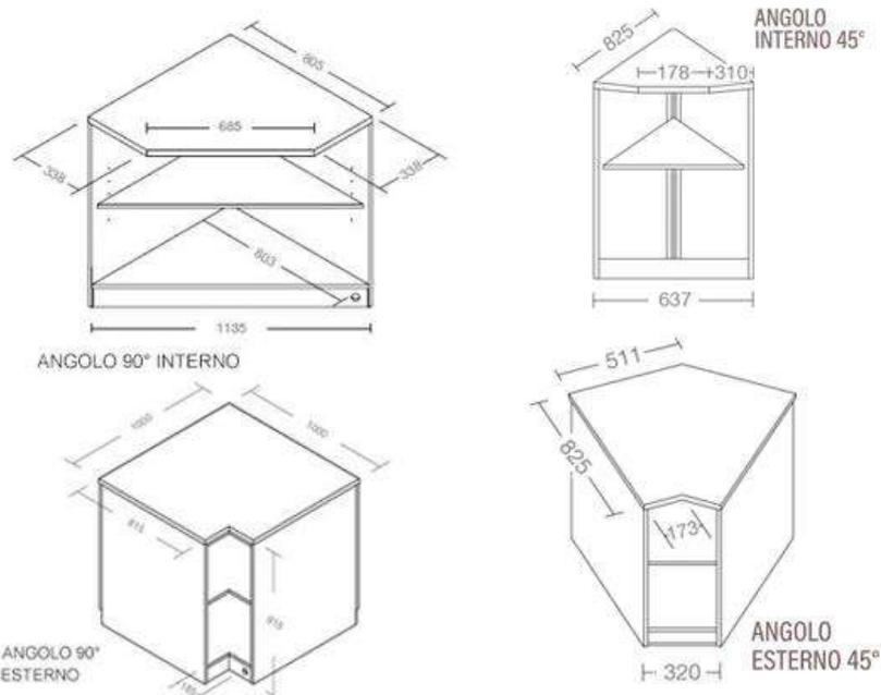
Banco ad Angolo, linea Basic, composto da struttura in legno nobilitato colore Grafite, con piano interno regolabile in altezza, zoccolo posteriore ispezionabile e zoccolo anteriore in ferro verniciato Micaceo. Montato su piedini metallici regolabili in altezza, Top di Serie in laminato colore Ardesia Frontale in legno di colore Grafite.
