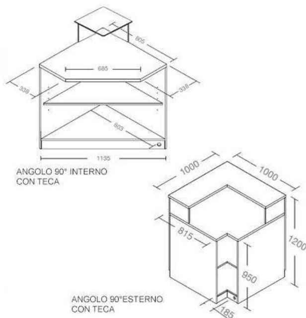
Banco ad Angolo con teca in vetro, linea Basic, composto da struttura in legno nobilitato colore Grafite, con piano interno regolabile in altezza, zoccolo posteriore ispezionabile e zoccolo anteriore in ferro verniciato Micaceo. Montato su piedini metallici regolabili in altezza, Top di Serie in laminato colore Ardesia Frontale il legno colore Grafite, teca in vetro alta 25 cm con vetro temprato.
