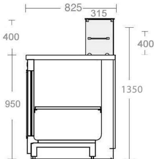
Banco Refrigerato Statico con castello in vetro alto, linea Basic, composto da struttura portante in tubolare d'acciaio verniciato a polveri e piedi regolabili, e zoccolo anteriore in ferro verniciato Micaceo, motore incorporato, Temperatura +4°C +8°C, cella in acciaio inox con sportelli, Top di Serie laminato colore Ardesia e Frontale in legno di colore Grafite, banco che necessita di scarico dell'acqua, castello in vetro alto 40 cm. con piano intermedio.
