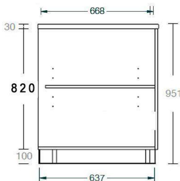
Banco Cassa Neutro linea Bistrot 66 composto da struttura in legno nobilitato colore Grafite, con piano interno regolabile in altezza, zoccolo posteriore ispezionabile e zoccolo anteriore in ferro verniciato Micaceo. Montato su piedini metallici regolabili in altezza dall'interno mediante chiave a brugola, Top di Serie in laminato colore Ardesia Frontale il legno colore Easy a scelta. Banco fornito Smontato.
