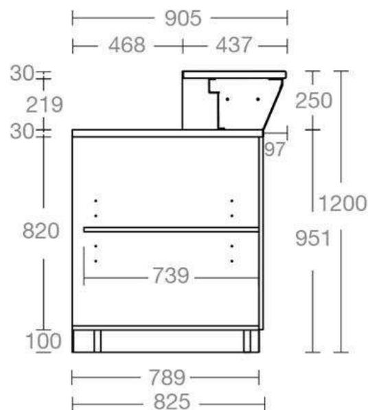
Banco Bar Neutro, linea Basic, composto da struttura in legno nobilitato colore Grafite, con piano interno regolabile in altezza, zoccolo posteriore ispezionabile in legno e zoccolo anteriore in ferro verniciato Micaceo. Montato su piedini metallici regolabili in altezza dall'interno mediante chiave a brugola, Bancalina e Piano di lavoro di Serie in laminato colore Ardesia, con carter sotto bancalina in ferro colore Micaceo, Frontale in legno di colore Grafite.
