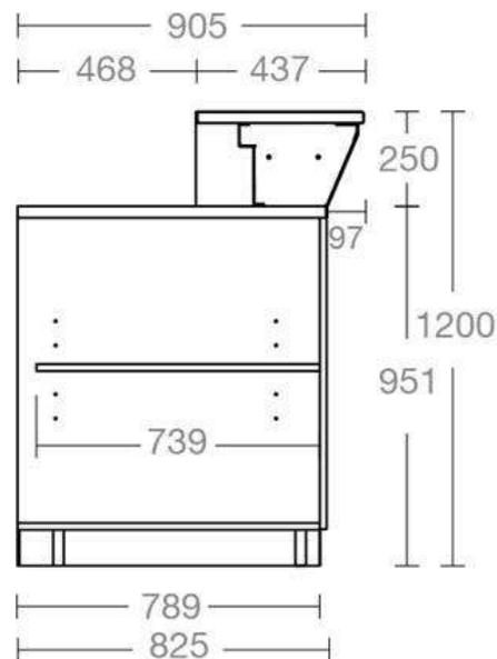
Banco Bar ad angolo Neutro, linea Basic, composto da struttura in legno nobilitato colore Grafite, con piano interno regolabile in altezza, zoccolo posteriore ispezionabile in legno e zoccolo anteriore in ferro verniciato Micaceo. Montato su piedini metallici regolabili in altezza, Bancalina e Piano di lavoro di Serie in laminato colore Ardesia, con carter sotto bancalina in ferro colore Micaceo, Frontale in legno di colore Grafite.
