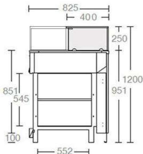
Banco "Drop In" Caldo Secco con teca in vetro, linea Basic, composta da struttura portante in tubolare d'acciaio verniciato a polveri e piedi regolabili, Frontale in legno di colore Grafite, con piano interno regolabile in altezza, teca in vetro alta 25 cm con vetro temprato, piano espositivo in vetro bianco temperato con serigrafia resistiva, Temperatura +30°C +80°C, zoccolo anteriore in ferro verniciato Micaceo, con scorrevoli ed illuminazione al led.
