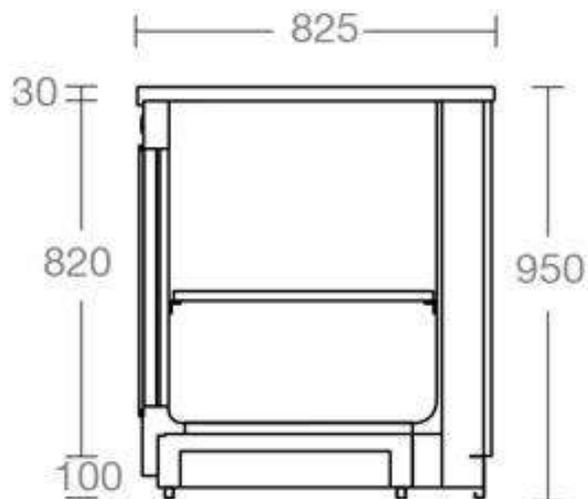
Banco Refrigerato Statico H. 95, linea Basic, composto da struttura portante in tubolare d'acciaio verniciato a polveri e piedi regolabili, e zoccolo anteriore in ferro verniciato Micaceo, motore incorporato, Temperatura +4°C +8°C, cella in acciaio inox con sportelli, Top di Serie in laminato colore Ardesia e Frontale in legno di colore Grafite, banco che necessita di scarico dell'acqua.
