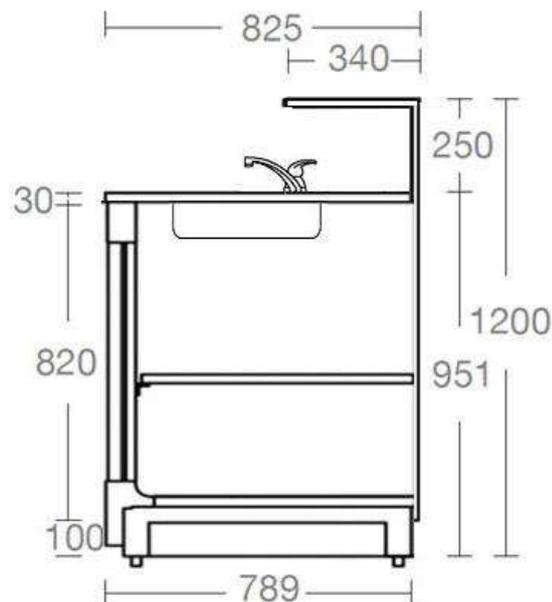
Banco Bar Refrigerato statico linea Basic, composto da struttura portante in tubolare d'acciaio verniciato a polveri e piedi regolabili e zoccolo anteriore in ferro verniciato Micaceo, motore incorporato e Temperatura +4°C +8°C cella in acciaio inox con sportelli, lavello da diametro 42 con erogatore a leva, piano di lavoro in acciaio inox AISI 304 finitura Scotch Brite, Bancalina di Serie in laminato colore Ardesia, Frontale in legno di colore Grafite, banco che necessita di scarico dell'acqua.
