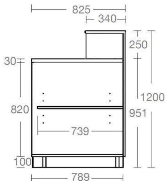
Banco Bar ad angolo Neutro, linea Basic, composto da struttura in legno nobilitato colore Grafite, con piano interno regolabile in altezza, zoccolo posteriore ispezionabile in legno e zoccolo anteriore in ferro verniciato Micaceo. Montato su piedini metallici regolabili in altezza, Bancalina e Piano di lavoro di Serie in laminato colore Ardesia, Frontale in legno di colore Grafite.
