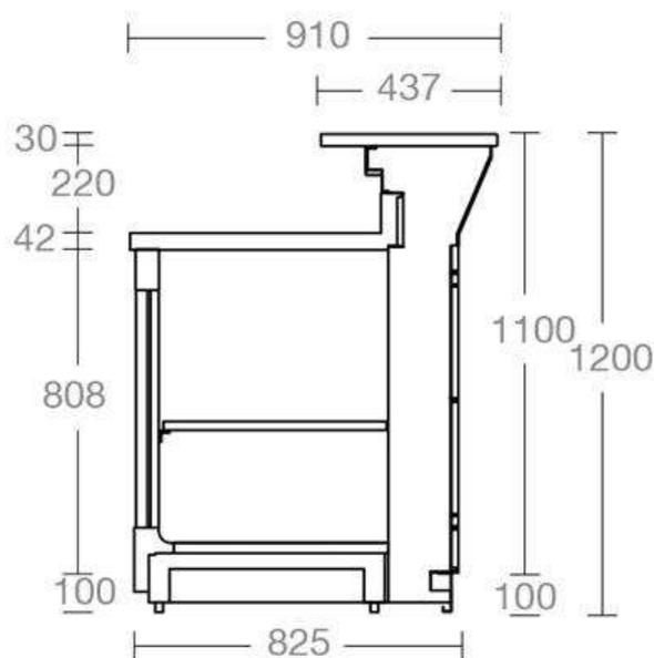
Banco Bar Refrigerato statico linea Basic, composto da struttura portante in tubolare d'acciaio verniciato a polveri e piedi regolabili e zoccolo anteriore in ferro verniciato Micaceo, motore incorporato e Temperatura +4°C +8°C cella in acciaio inox con sportelli, piano di lavoro in acciaio inox AISI 304 finitura Scotch Brite, Bancalina di Serie colore Ardesia, carter sotto bancalina colore Micaceo, Frontale in legno di colore Grafite, banco che necessita di scarico dell'acqua.
