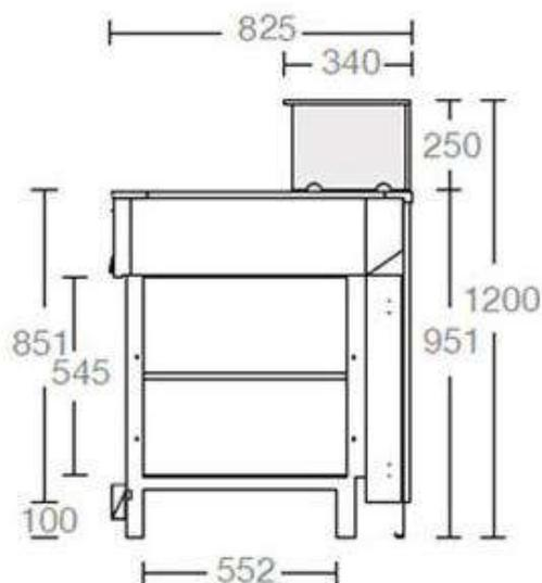
Banco "Drop In" Caldo Secco con teca in vetro, linea Basic, composta da struttura portante in tubolare d'acciaio verniciato a polveri e piedi regolabili, Frontale in legno di colore Grafite, con piano interno regolabile in altezza, teca in vetro alta 25 cm con vetro temprato, piano espositivo in vetro bianco temperato con serigrafia resistiva, Temperatura +30°C +80°C, zoccolo anteriore in ferro verniciato Micaceo.
