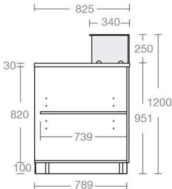
Banco Neutro con teca in vetro, linea Basic, composto da struttura in legno nobilitato colore Grafite, con piano interno regolabile in altezza, zoccolo posteriore ispezionabile in legno e zoccolo anteriore in ferro verniciato Micaceo. Montato su piedini metallici regolabili in altezza dall'interno mediante chiave a brugola, Top di Serie in laminato colore Ardesia Frontale il legno colore Grafite, teca in vetro alta 25 cm con vetro temprato.
