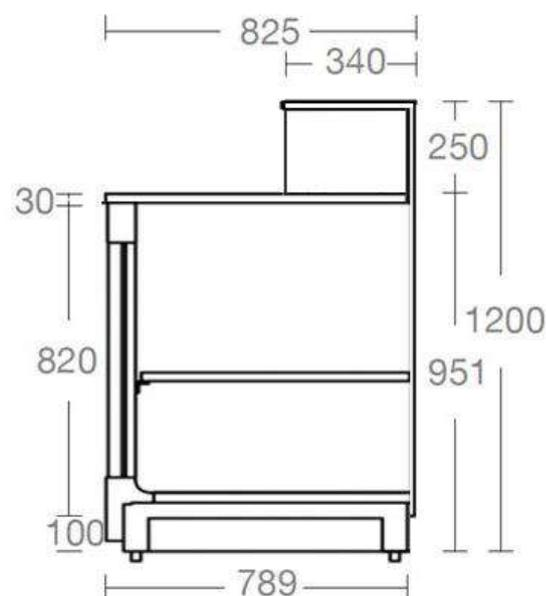
Banco Bar Refrigerato statico linea Basic, composto da struttura portante in tubolare d'acciaio verniciato a polveri e piedi regolabili e zoccolo anteriore in ferro verniciato Micaceo, motore incorporato e Temperatura +4°C +8°C cella in acciaio inox con sportelli, piano di lavoro in acciaio inox AISI 304 finitura Scotch Brite, Bancalina di Serie in laminato colore Ardesia, Frontale in legno di colore Grafite, banco che necessita di scarico dell'acqua.
